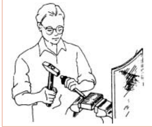
شكل (٥٨) عامل يستخدم الإزميل بالطريقة الصحيحة
