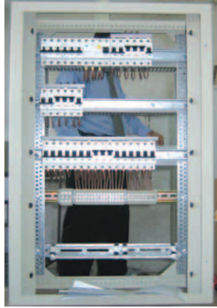
الشكل (١٤-١) : لوحة تجميع كهربائية صناعية أثناء التجميع
