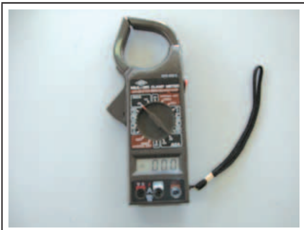
الشكل (١-١) : جهاز القياس ذو الملقط Clamp-on ammeter
