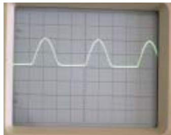
الشكل (١٧): اشارات كهربائية قبل وبعد التقويم كما تظهر على شاشة جهاز راسم الاشارة
