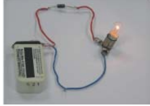
الشكل (٣): اختبار عملي لانحياز الثنائي شبه الموصل
