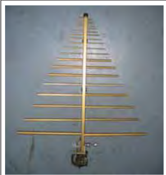
الشكل (١): الهوائي اللوغاريتمي - الدوري
